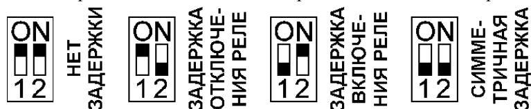
Рис. 6. Внутренние переключатели датчика.
